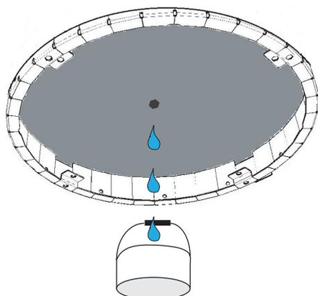
IT - Assicurarsi di svuotare e pulire l'impianto idrico prima di collegare il corpo soffione.
