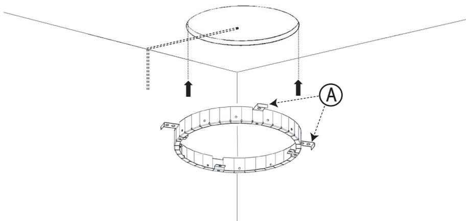
IT - Per il fissaggio in muratura servirsi, se necessario, delle alette aggiuntive A.
