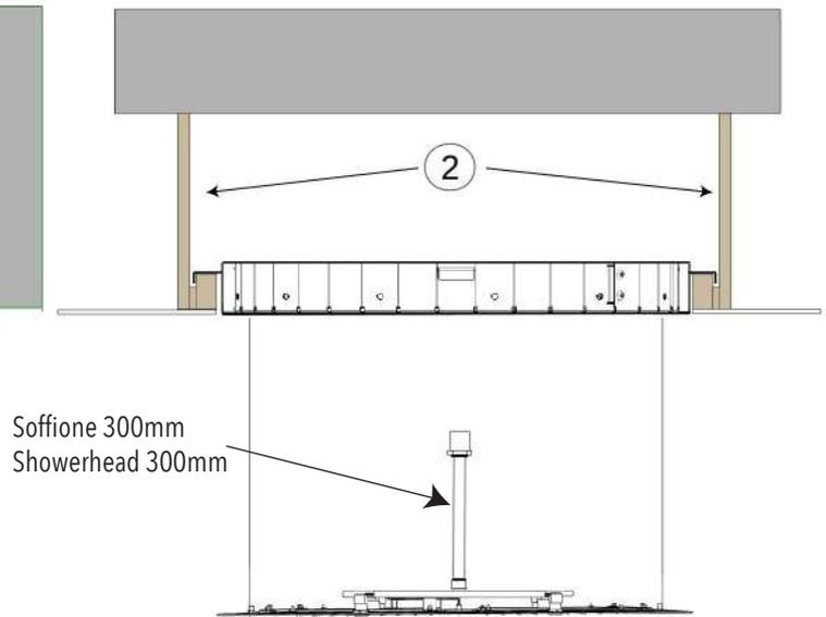
IT - Prima di agganciare il controtelaio del soffione al telaio di supporto assicurare il soffione al telaio per mezzo di cavi di sicurezza Fig.6(1); se il telaio fosse agganciato al controsoffitto (Fig.7) per maggiore sicurezza e stabilità assicurare anche il telaio a dei ganci di sicurezza (2) (non forniti) al soffitto in muratura.
