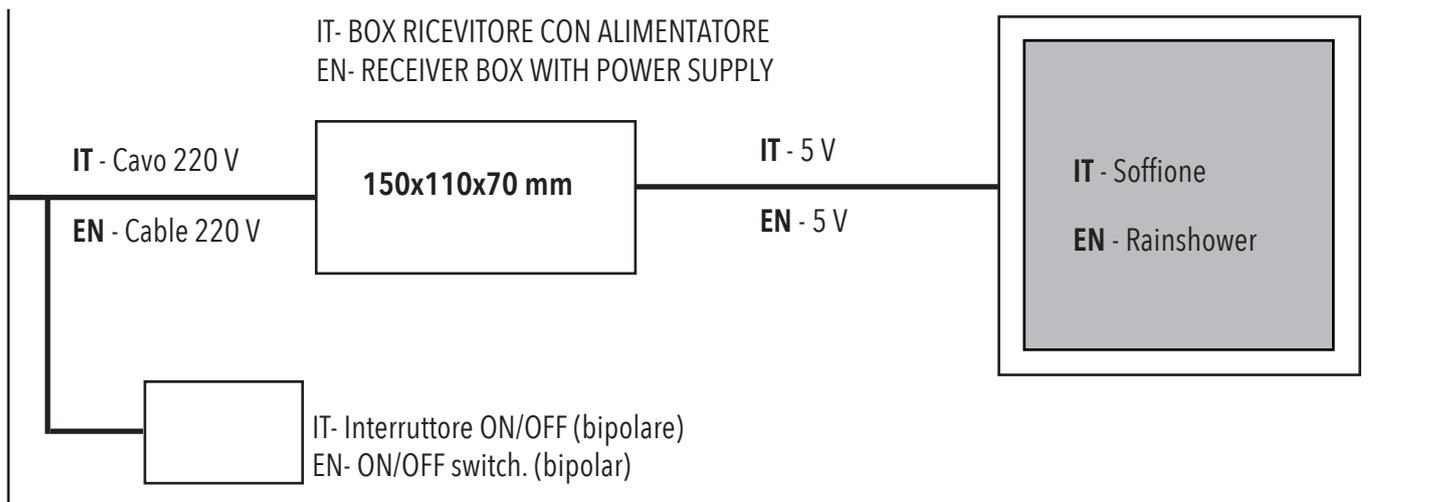
IT - SCATOLA DI DERIVAZIONE CON BOX RICEVITORE E ALIMENTATORE
