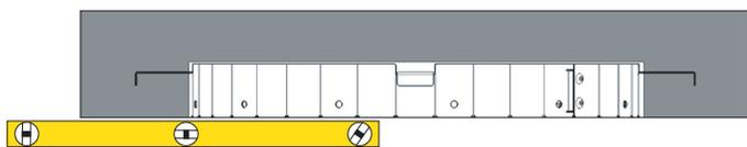
IT - Prima di fissare il telaio, assicurarsi che quest'ultimo sia correttamente allineato al soffitto.
