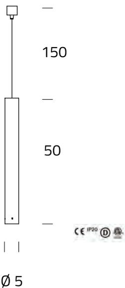
Corps en verre borosilicate transparent qui abrite à l'intérieur un dissipateur en métal anodisé naturel, à ailettes, qui permet une meilleure dissipation de la chaleur produite par la source de lumière.
