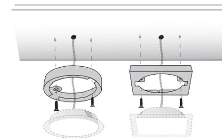
Si pose encastrée - Diamètre découpe : 56 mm.
